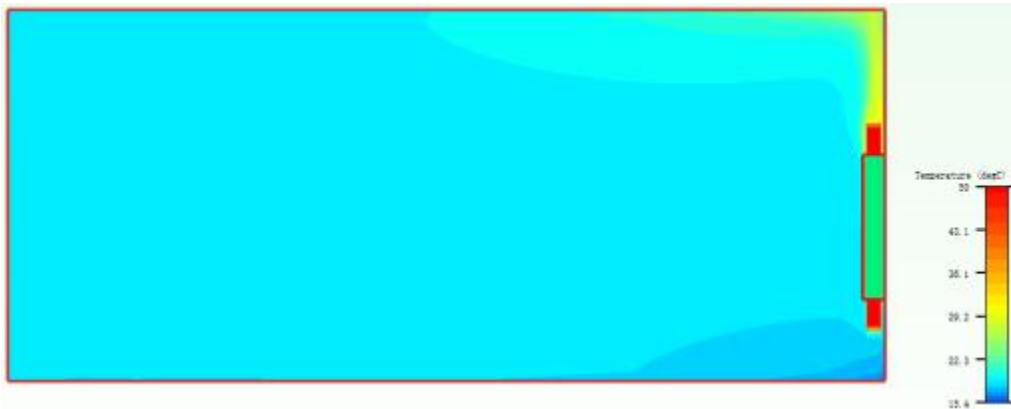
图 16 房间空气热仿真温度云图 (纵向中截面) (Flotherm 版)
