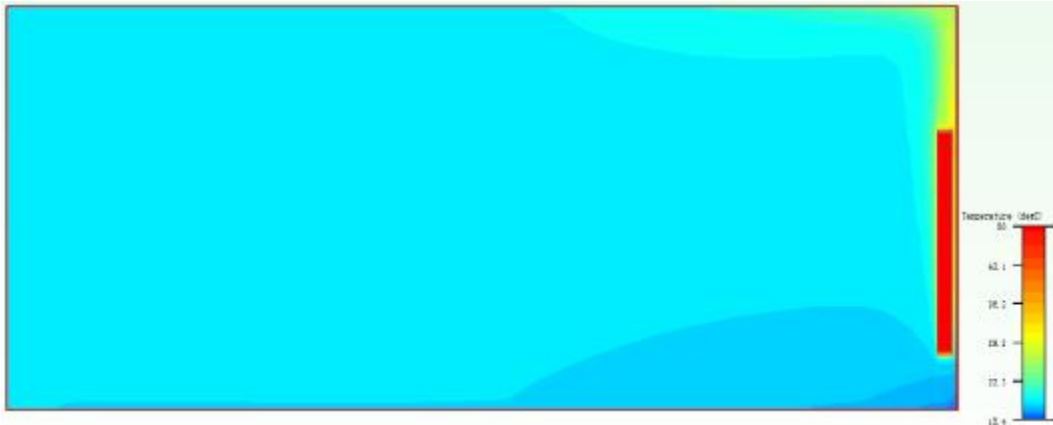
图 10 房间空气热仿真温度云图（纵向中截面）（Flotherm 版）
